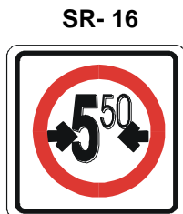
ANCHURA LIBRE RESTRINGIDA
