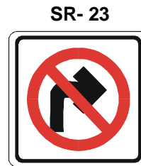
PROHIBIDO LA VUELTA A LA DERECHA
