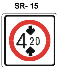
ALTURA LIBRE RESTRINGIDA
